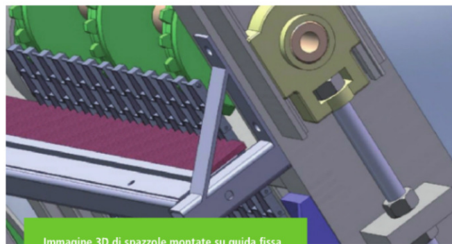
Immagine 3D di spazzole montate su guida fissa
